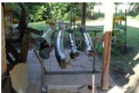
Szőlőoszlopok bitumenes kezelése
