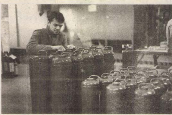
A Pyrocoop Tűzvédelmi Kft. szakemberei alkatrészekből új poroltókat szerelnek össze, illetve felújítják, karbantartják a régi készülékeket Cegléden Erdősi Ágnes felvétele
